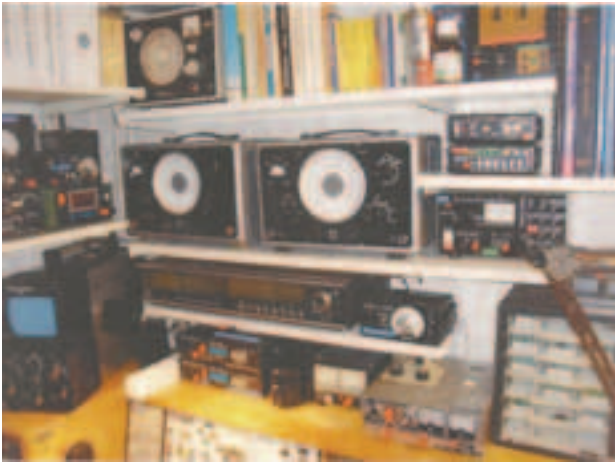
Belangrijkste nieuwe meetapparatuur: PhilipsTV-beeldgenerator, dubbelstraals oscilloscoop Telequipment D61a, Sinclair digitale multimeter DM2, Philips toongenerator en gestabiliseerde voeding, Philips signaal injector en -tracer enzovoorts.
