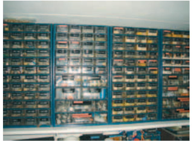
Passieve en actieve componenten keurig gerangschikt in kastjes met laden. E-12 reeks weerstanden, condensatoren, halfgeleiders, IC's etc.
